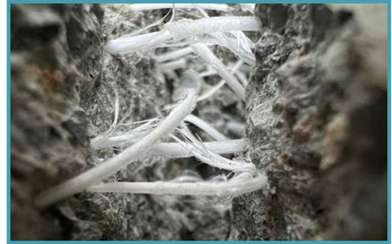
Plak Kırım Deneyi Sonrası Görünüm
